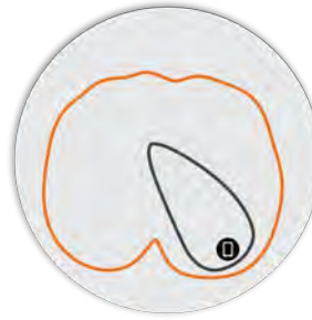
Figure 4. R350 2,4 GHz: patrones de antena en elevación
