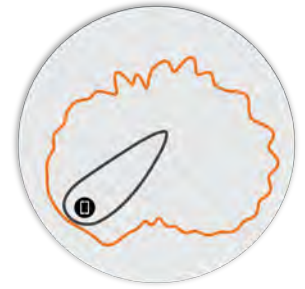
Figure 5. R350 5 GHz: patrones de antena en elevación
