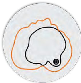
Figure 3. R350 5 GHz: patrones de antena en acimut
