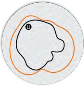
Figure 2. R350 2,4 GHz: patrones de antena en acimut
